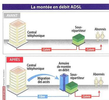
C'est l'installation de la fibre optique entre le central de Maillebois et l'armoire de répartition téléphonique de Blévy qui a permis cette opération. Le câble cuivre a été remplacé par la fibre optique. La desserte vers l'abonné, elle, reste en câble cuivre. Cette technique s'appelle ADSL-VDSL. Elle permet le service de l'ADSL dans les zones avec peu d'habitations.
