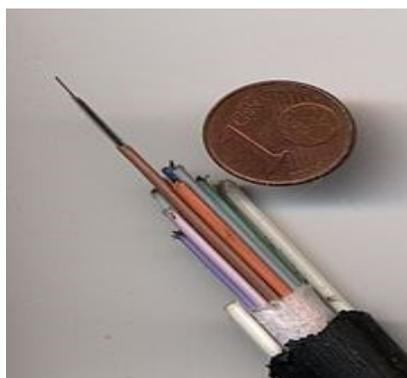
Une fibre optique est un fil en verre très fin qui a la propriété d'être un conducteur de la lumière et sert dans la transmission de données et de lumière. Elle offre un débit d'information nettement supérieur à celui des câbles coaxiaux et peut servir de support à un réseau par lequel transitent aussi bien la télévision, le téléphone, la visioconférence ou les données informatiques.
